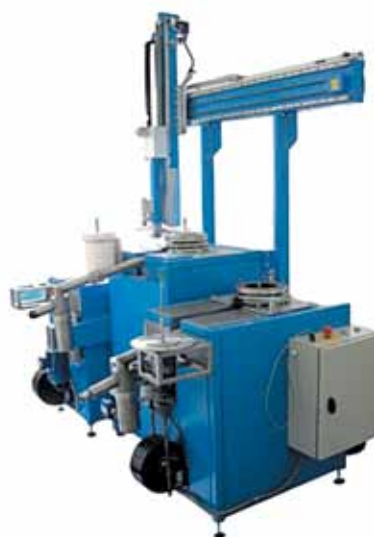
Рисунок 4. Установка SKW-2 — карботест
